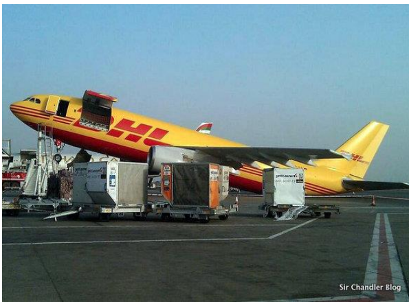
Fig. Avión con centro de gravedad retrasado.
